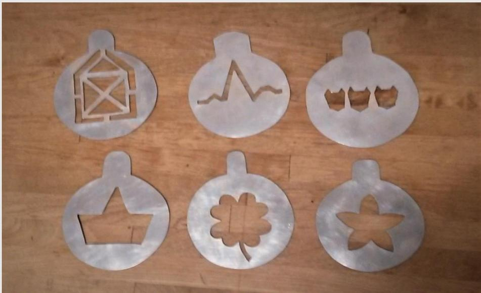
Bis zum individuellen Gebrauchsgegenstand ist es ein ganzes Stück Arbeit: Entwicklung eines ansprechenden Designs, Herstellung einer Papierschablone, Übertragung des Entwurfs auf das Aluminiumblech, Bohren, Sägen, Einspannen, Entgraten, Feilen, Polieren.
